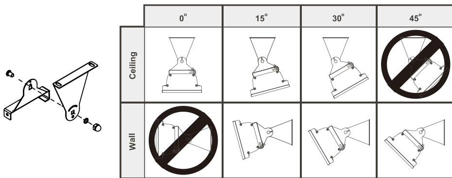
7. Cuelgue el dispositivo en los soportes y asegúrelo firmemente en su lugar con las placas de fijación del soporte de montaje apretando los pernos.
