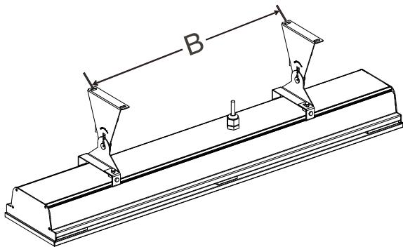
6. Coloque los soportes de montaje de ángulo ajustable en el ángulo deseado y fije los soportes con una llave.
