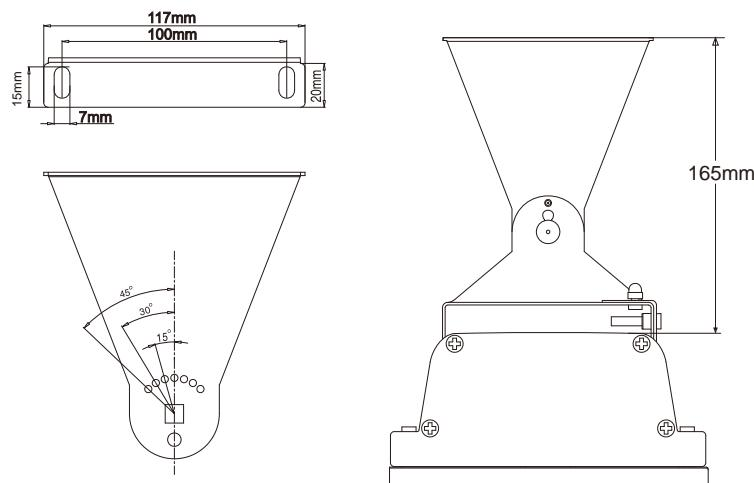
4. Il corretto processo di installazione, come indicato nello schema sopra riportato, prevede il posizionamento del dispositivo sul soffitto, disponendo il perno o i travetti strutturali in modo da garantire un fissaggio sicuro del dispositivo.
