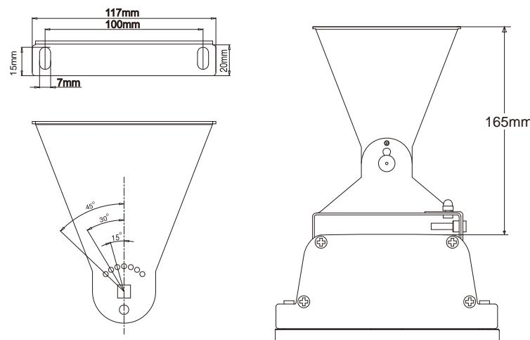
4. Für den korrekten Installationsvorgang, wie in der obigen Abbildung dargestellt, wählen Sie die Position des Geräts an der Decke aus, indem Sie einen Bolzen oder Strukturbalken anbringen, um eine sichere Befestigung des Geräts zu gewährleisten.
