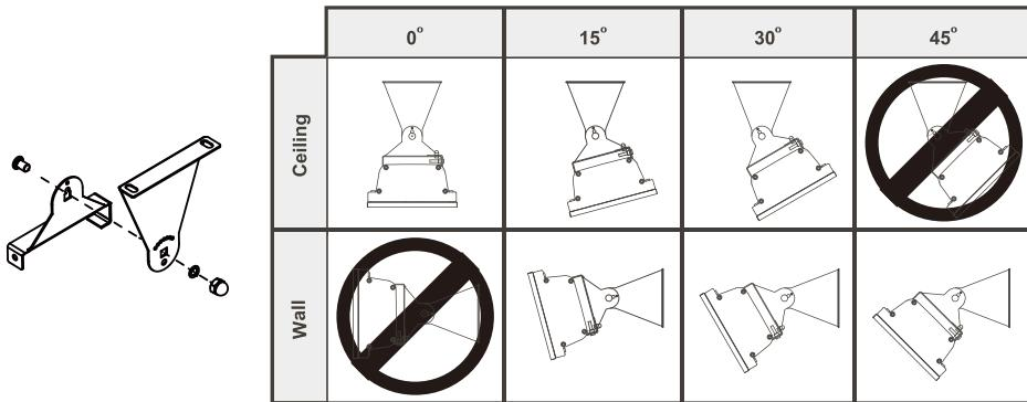
7. Accrochez l'appareil de chauffage aux supports et fixez-le fermement avec les plaques de verrouillage du support de montage en serrant les boulons marqués A.
