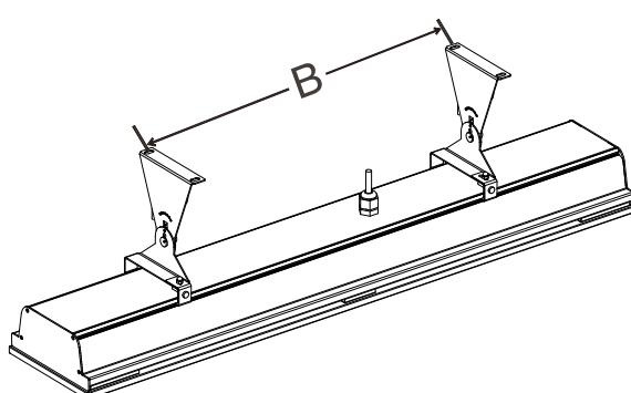
6. Stellen Sie die einstellbaren Winkelhalterungen auf den gewünschten Winkel ein und befestigen Sie die Halterungen mit einem Schraubenschlüssel.
