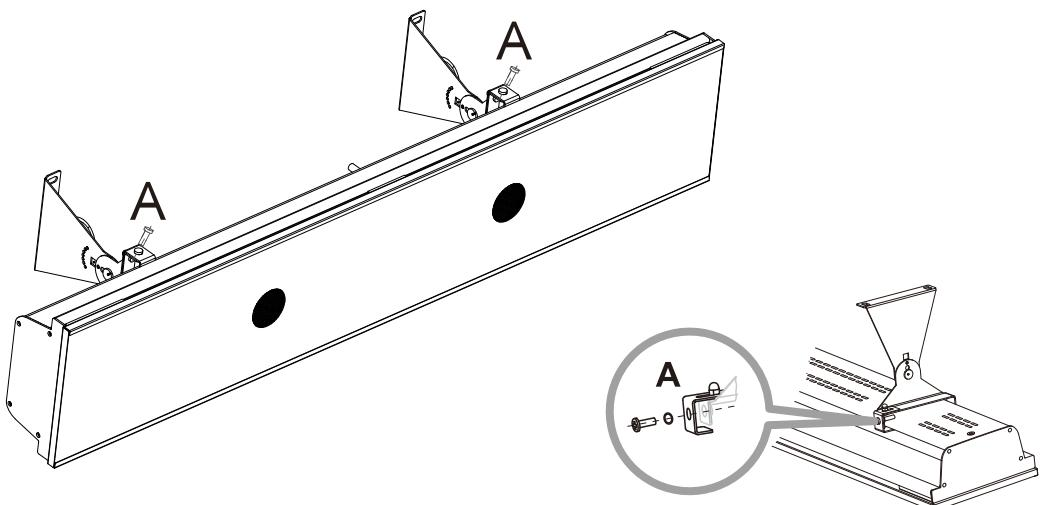
**BEACHTEN SIE:** Je nach Material und Ausführung der Deckenstrukturelemente muss das Gerät mit den richtigen Befestigungselementen gesichert werden. Das Gewicht des Heizgeräts beträgt bis zu 5,9 kg. Der Installationsort muss das 5-fache Gewicht des Geräts halten können.
