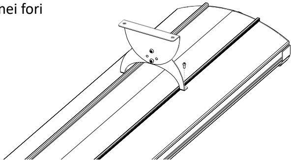
I supporto da fissare al muro presenta una serie di fori che permettono di fissare il riscaldatore in 6 diverse posizioni.
