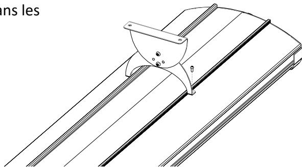
Le support à fixer au mur comporte une série de trous qui permettent de fixer le radiateur dans 6 positions différentes.
