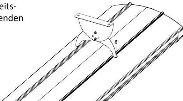
Die an der Wand oder Decke zu befestigende Halterung weist eine Reihe an Löchern auf, die eine Befestigung des Heizstrahlers in 6 verschiedenen Positionen ermöglichen.
