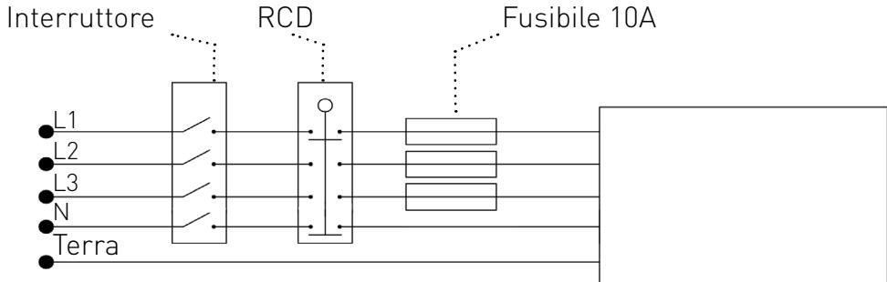
Se il prodotto viene utilizzato all'interno, deve essere comandato da un cronotermostato. Per controllare un prodotto con collegamenti trifase con un cronotermostato in monofase ci sarà bisogno di un teleruttore e collegare il tutto seguendo lo schema sottostante.
