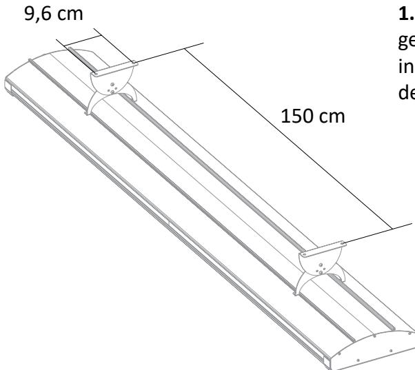
1. Mit einem Bohrer mit geeigneter Spitze vier Löcher in die Mauer bohren, wie in der Graphik gezeigt.
