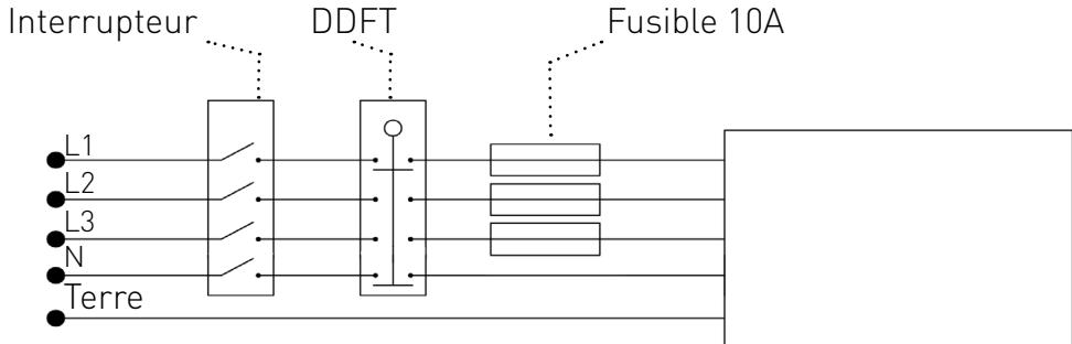
Si le produit est utilisé à l'intérieur, il doit être contrôlé par un chronothermostat. Pour contrôler un produit avec des connexions triphasées avec un chronothermostat monophasé, vous aurez besoin d'un interrupteur de télécommande et de tout connecter en suivant le schéma ci-dessous.
