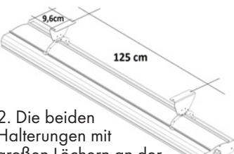
2. Die beiden Halterungen mit großen Löchern an der Wand befestigen. Dazu Schrauben und Dübel geeigneter Größe verwenden. Die Dübel sollten mindestens das 5-fache des Heizstrahlers halten können.
