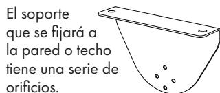
La fijación del foco en posiciones diferentes permite.
