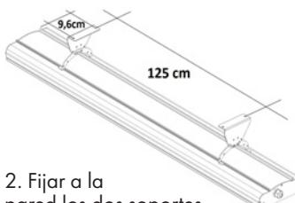
2. Fijar a la pared los dos soportes con orificios grandes utilizando tornillos y tacos de la medida adecuada.
